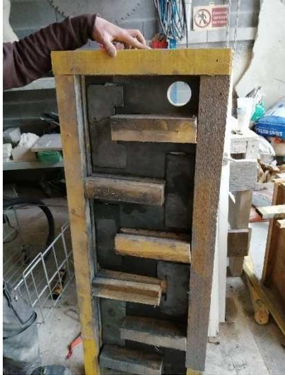
**Etape 5** : prévoir une ouverture pour faire la jonction entre la colonne solaire (chauffante) et le séchoir (avec les clayes)
